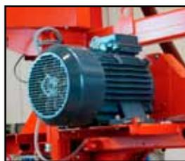
Motor eléctrico de 7.5 kW
