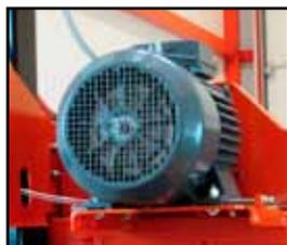
Motor eléctrico de 5,5 kW
